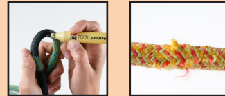
Mitte neu markieren Leichte Mantelbeschädigung
