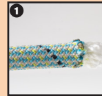
Mantelverschiebung - Mantel ist kürzer -
